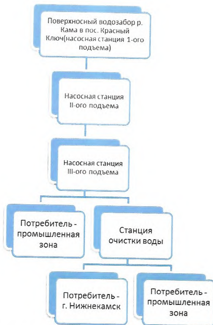
Рис.1.1.2 Структура централизованной системы водоснабжения
